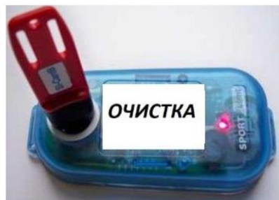
Рис. 1. Световой индикатор при успешной очистке контактного ЧИПа
