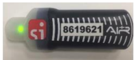
Рис. 4. Периодически мигающий зелёный световой индикатор говорит о том, что ЧИП SIAC активирован и готов к бесконтактной отметке
