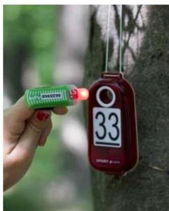
Рис. 5. Отметка в станции ЧИПом SIAC
