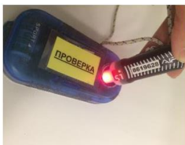
Рис. 3. Световой индикатор при успешной отметке (активации) ЧИПа SIAC
